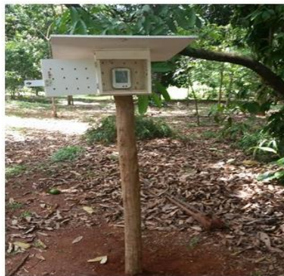
Figura 2 - Modelo do termohigrômetro digital e do abrigo. Fonte: Monteiro (1990b).
